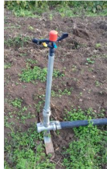
Asperseur Tropical : débit de 1m 3 /h, rayon d'action de 12 m
