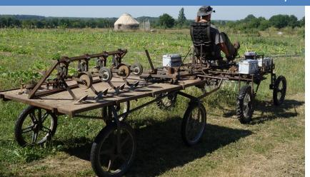
Exemple de convoyage des cadres et éléments de binage : un charriot porte tout (auto-construit également) est attelé à l'aggrozouk.
