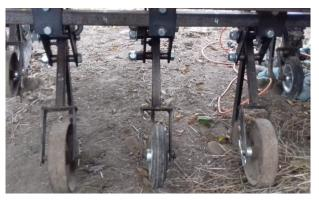
Pate d'oie : l'élément le plus utilisé en routine
