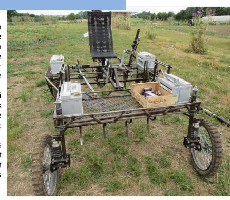
Le système de pédale a également été retiré car il était finalement assez peu utilisé et gênait plus qu'autre chose l'opérateur, notamment pour piloter correctement l'engin pendant les interventions de binage.
